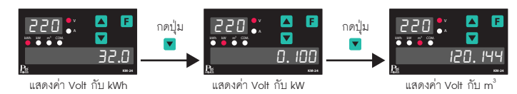
แสดงค่า Volt กับ kWh แสดงค่า Volt กับ kW แสดงค่า Volt กับ m³
